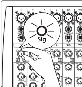
9. Tournez le bouton de gain de la voie 1 dans le sens horaire tout en regardant l'indicateur de signal. Réglez le bouton de gain de la voie 1 de façon à ce que le voyant d'écrêtage rouge du signal s'allume puis rabaissez-le jusqu'au retour dans le vert juste en-dessous de l'écrêtage pour le niveau d'entrée le plus fort.
