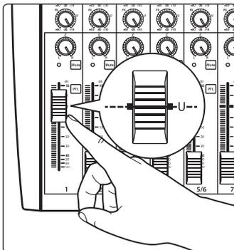
10. Montez la commande de niveau de la voie 1 jusqu'au gain unitaire (repéré par un « U »).
