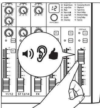
11. Montez le niveau du mixage principal (Main) jusqu'à ce que puissiez confortablement entendre votre microphone dans les enceintes.
